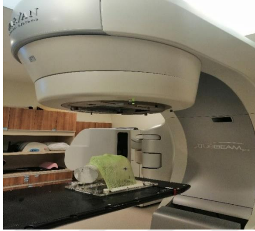
Resim 5.3.8. : Truebeam STx tedavi cihazı için rando fantomun örnek bir tedavi öncesi setup görüntüsü
