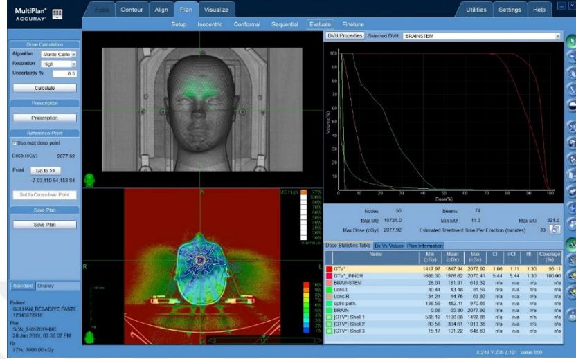
Resim 5.3.4 : Cyberknife tedavi cihazında Ev Yapımı Fantomun Monte Carlo doz hesaplama algoritması ile doz hesabı
